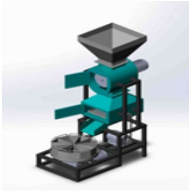
Gambar 7. Desain Alat Hammer Mill Sample Divider yang telah dimodifikasi
