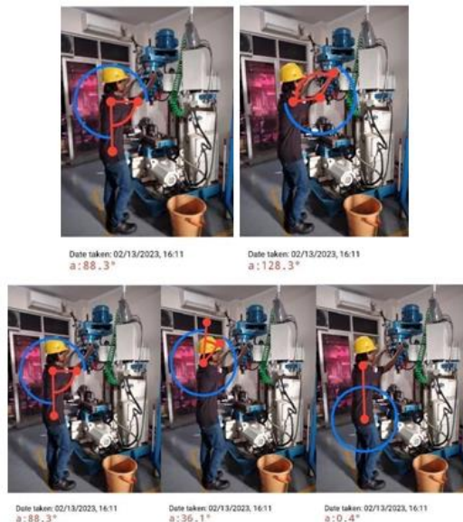
Gambar 2. Postur Penilaian Kerja Operator Mesin Milling Sumber : (Peneliti, 2023)
