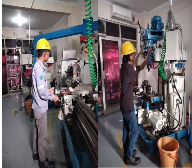
Gambar 1. Posisi Kerja Operator Mesin Milling Sumber : (Penulis, 2023)
