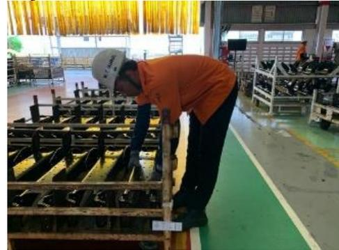
Gambar 1. Proses pengangkatan *part crossmember* dari lantai ke *pallet*
