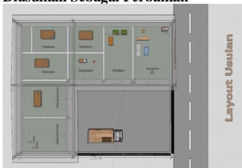
**Gambar 11.** Lay Out Proses Produksi yang Diusulkan Sebagai Perbaikan
