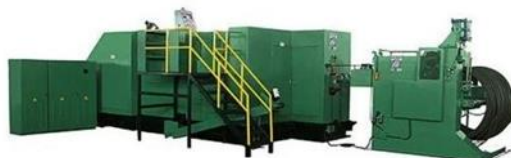
Gambar 2. Mesin Produksi Mur ( Disch Caller ) Sumber : dokumen pribadi, 2024
