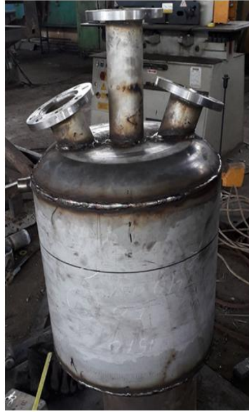
Gambar 5. Reboiler Kolom Distilasi Vakum Berikut Jacket Pemanas Uap Yang Sudah Tertutup
