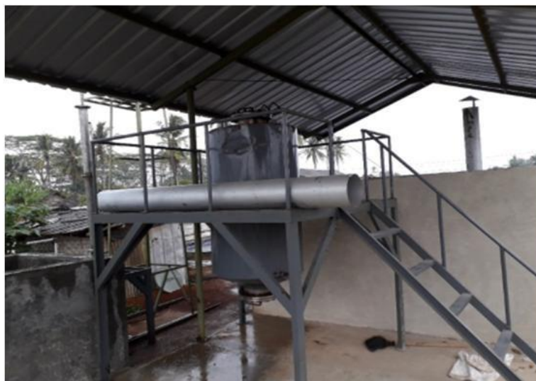
Gambar 3. Digester Kapasitas 1000 L dan Unit Penyediaan Steam Berbahan Bakar Gas
