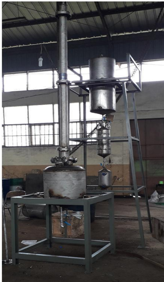
Gambar 6. Kolom Distilasi Vakum Berikut Kondensor dan Dekanter
