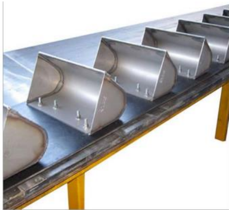
Gambar 2. Bucket yang dipasang pada drum pulley elevator
