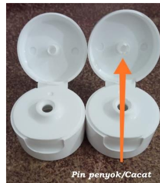
Gambar 5. Reject Pin Penyok (Sumber: Data perusahaan)
