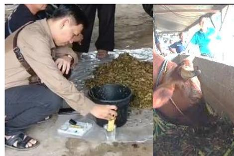
**Gambar 9.** Pengukuran kadar pH hasil fermentasi pakan dan uji palatabilitas ternak sapi
